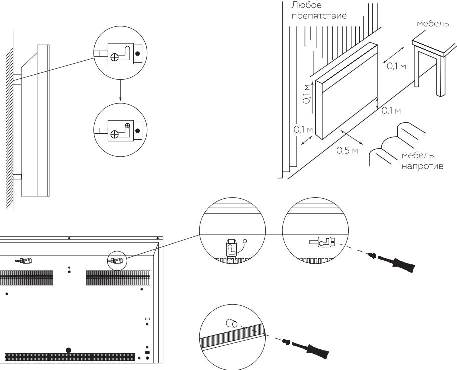
1. Вставьте кронштейн в отверстие, поверните его против часовой стрелки на 90°, закрепите его винтом;
