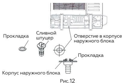
Вставьте прокладку в сливной штуцер, затем вставьте штуцер в отверстие поддона наружного блока, поверните на 90 градусов, чтобы зафиксировать его. Наденьте на штуцер сливной шланг (можно приобрести в магазине), если необходимо слить конденсат из наружного блока во время работы в режиме обогрева.
